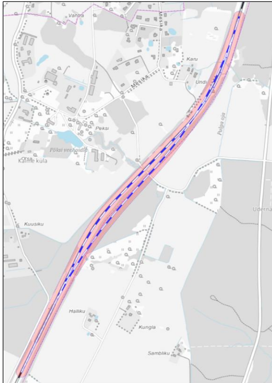
Joonis 25. Planeeritud Tartu-Valga raudtee õgvendus (kõverates 454,4-456,6 km) koos kaitsevööndiga (30 m teljest).
